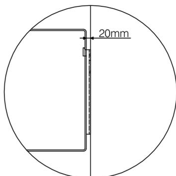
Fixez le support au mur avec des vis adaptées au type de matériau du mur image 1
